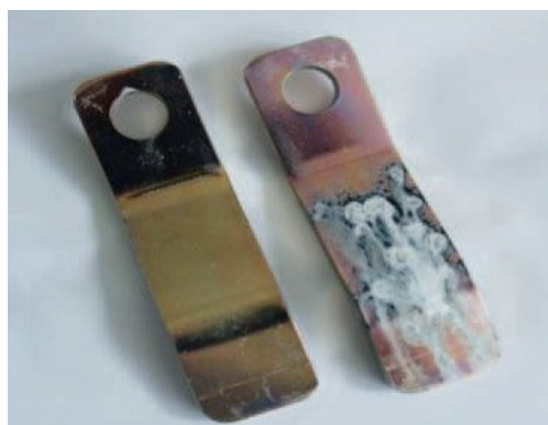
TOPAS 3100 + PROSEALXZ 111 (+ PROSEAL Nanoadditiv) + SURFASEAL WL150 po 840 h według DIN EN ISO 9227
