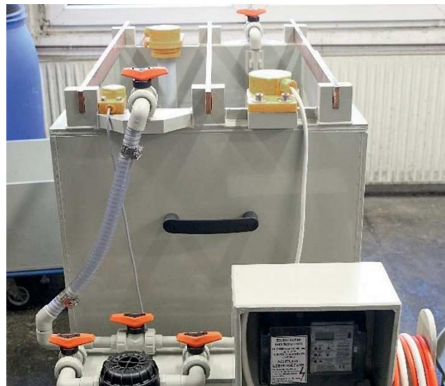
Rys. 3 Wanna do testów bębnowych bezpośrednio w zakładzie. Wanna jest wyposażona w pompę, podgrzewacz i zestaw do wymiany jonowej
