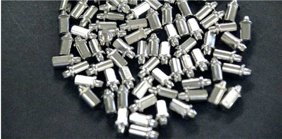
Rys. 2 Przygotowane próbki u klienta (20 A, 30 min., 52 °C). Grubość warstwy wynosiła 0,18-0,29 \mu
